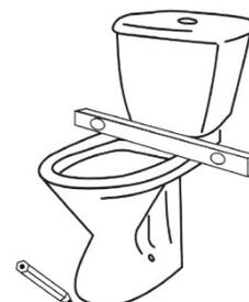
6.3. При необходимости для сглаживания неровностей на полу на прилегающие поверхности необходимо нанести выравнивающий материал. Для этого подходят как готовые сухие смеси, так и самостоятельно приготовленная смесь песка и цемента.
